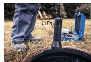
Mesure de boue d'une fosse
